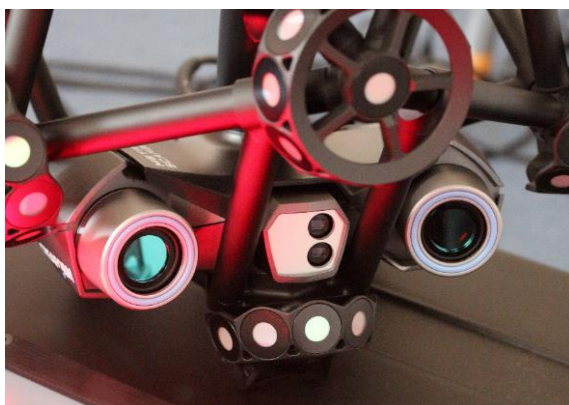
Obr. 3. MetraSCAN 350 (C-track – nahoře, skenovací hlava – dole)
