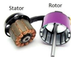
Obr. 17. Motor v rozebraném stavu [Rotorama 2019]
