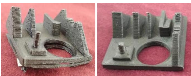
Obr. 6. Ukázka výtisků z PA s uhlíkovými vlákny [Rajaganesh 2019]
