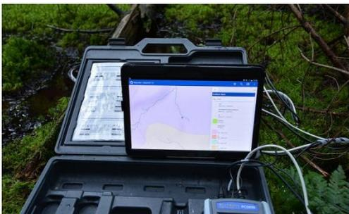
Mobiles Gerät für die Feldforschung, das von den Studierenden gemeinsam genutzt wird (Tablett mit GIS-Karte zur Erfassung von Geodaten, Messgeräte für chemische Grundwerte) (Jiří Šmída, Technical University in Liberec)
